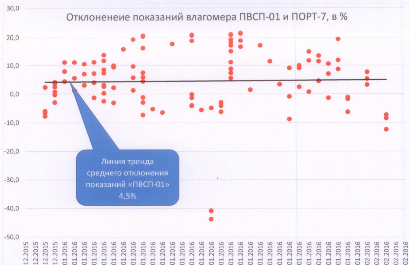
Рис. 11. Относительное отклонение показаний влагомера «ПВСП-01» и результатов анализа проб
